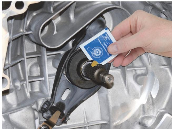
Fig. 2: Nabenprofil der Getriebeeingangswelle rundum leicht fetten
