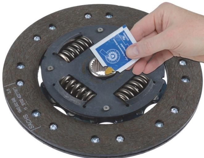
Fig. 1: Nabenprofil der Kupplungsscheibe rundum leicht fetten
