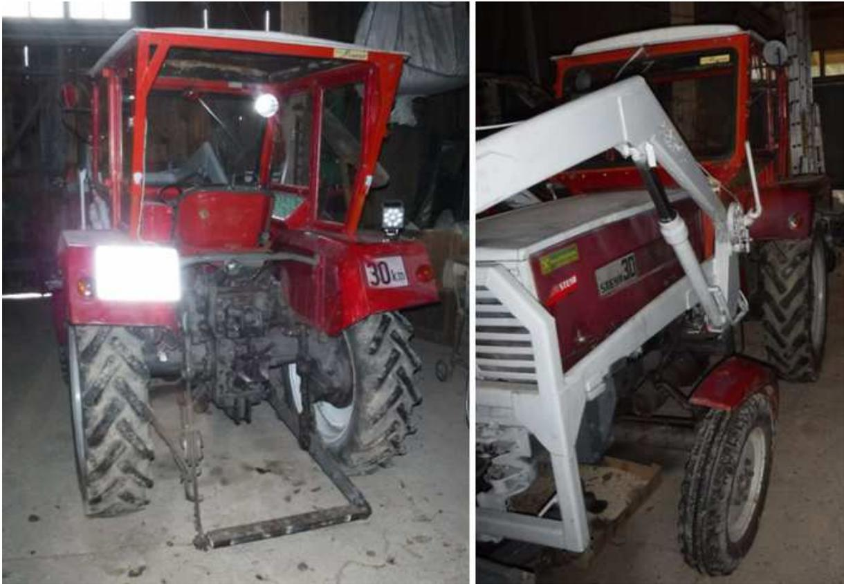
Nachdem einige der Kabeln vom Traktor bereits durchgebrannt / versprödet waren, musste der gesamte Kabelstrang erneuert werden. Außerdem wollte ich einen Trennschalter nachrüsten. Somit ist das einzig verbliebene Originalkabel (abgesehen von Endkabeln zu den Scheinwefern & Scheibenwischer) das Pluskabel der Batterie zum Starter. Alles andere ist neu (und das Pluskabel wird ggf. noch getauscht).
